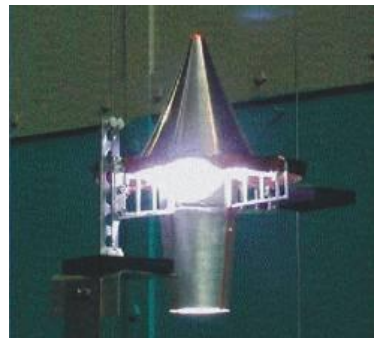
Рис. 31. Макет ЛРД на стартовой площадке при воздействии одиночного лазерного импульса
