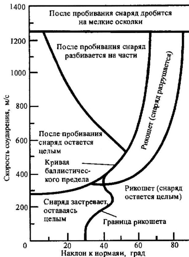
Рис. 9. Фазовая диаграмма, характеризующая соударение снаряда и преграды
