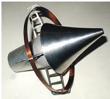
Рис. 30. Макет аэрокосмического лазерного реактивного двигателя для полетных экспериментов
