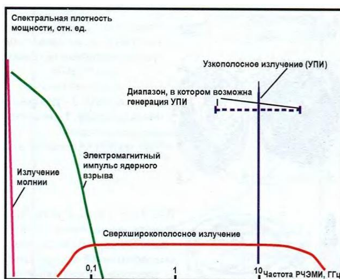
Рис. 26. Спектральные плотности мощности электромагнитного излучения, генерируемое источниками различных классов в радиочастотном диапазоне
