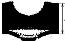
Рис. 14. Образование откола на тыльной поверхности преграды толщиной L
